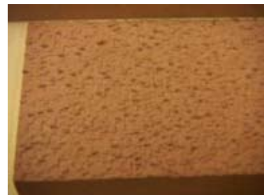
Figuras 23 y 24: Fichero CAD 3D (STL) y fabricación por micro-mecanizado de textura (Proyecto Syntex FP6-Fundación Prodiotec).
