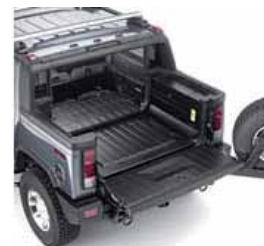
Fuente GM (General Motors) Varias partes del vehículo Hummer de GM han sido moldeadas con un polímero TPO aditivado con arcilla de tamaño nanométrico. www.compositesworld.com/
