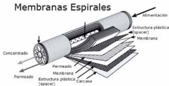
Fig. 1. Módulo de nanofiltración con membrana en espiral.
