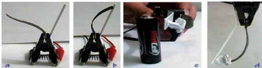
a) Pinza abierta b) Pinza cerrada al cambiar la polaridad c) y d) elevación de objetos.
