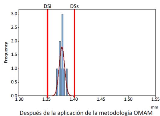
Los resultados de la prueba de concepto demuestran que la aplicación de la metodología OMAM permite reducir, de forma muy significativa, el error de fabricación de las piezas procedentes de procesos aditivos. Su uso puede facilitar la generalización de la fabricación aditiva a nivel industrial, puesto que permite superar la barrera que supone la falta de calidad dimensional y geométrica de las piezas en series medias y largas.
