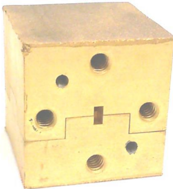
Ejemplo de prototipo de dispositivo de terahercios realizado mediante técnicas de fabricación aditiva.
