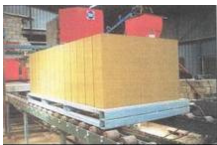
Bloques de 600mm x 900mm producidos en una prensa
