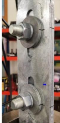
**Figura 3** Probeta ensayada durante la prueba de concepto en una de las máquinas de ensayo.
