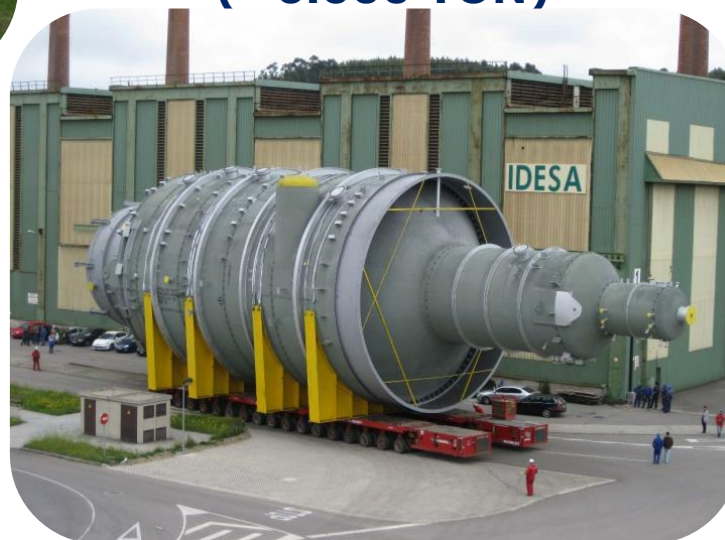
9 COLUMNAS DE VACÍO (~6.000 TON)
