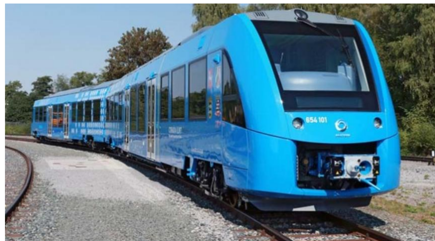
El primer tren con pila de hidrógeno de Alstom
