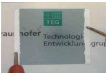
Laca transparente y conductora con nanotubos de carbono.
