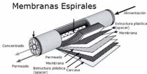
Fig. 1. Módulo de nanofiltración con membrana en espiral.
