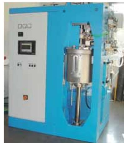
Horno de sinterización por descarga de plasma (Spark Plasma Sintering).
