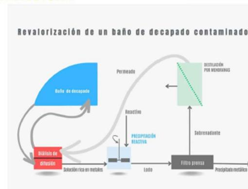
A modo de ejemplo, se muestra el esquema de la integración de las técnicas en la revalorización de un baño de decapado contaminado procedente del proceso electrolítico. El permeado es agua pura, que podrá ser empleada directamente en el módulo de DD para extraer el ácido.
