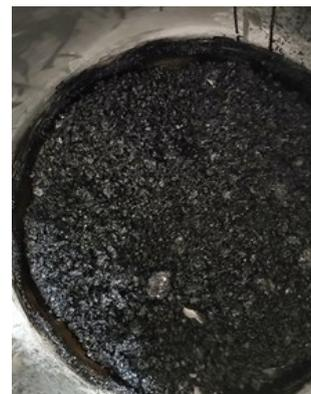
(c) mezcla asfáltica con adición de residuo
