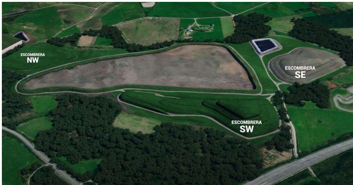
Figura 1.4.- Zona de las escombreras y el depósito. Escombrera SE en operación y escombrera NW restaurada. Escombrera SE restaurada y depósito en operación.
