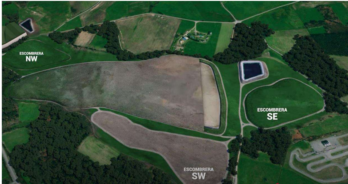
Figura 1.6.- Zona de escombreras y depósito durante las labores de restauración. Recubrimiento del depósito de estériles con el material procedente de las escombreras SW y SE desmanteladas.
